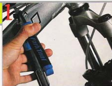
1 RENOVIACIÓN CABLES Y FUNDAS. Sustituiremos cable y fundas, midiendo las nuevas por la longitud de las antiguas. Retirando el tapón roscado de la maneta quedará lista para recibir el cable nuevo. Poner el piñón pequeño para facilitar la labor.
