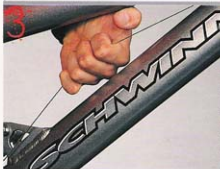
3 ESTIRANDO EL CABLE. Tirando fuertemente del cable con la mano nos aseguramos los topes encajan perfectamente y que no se va a estar provocando desajustes. Conviendrá aflojar el prisionero del cambio y volver a tensar ligeramente.
