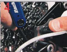
4 ACERCANDO EL CAMBIO. Seleccionamos el piñón grande y mediante el tornillo B acercamos al máximo la polea superior del cambio a la corona grande, pero sin que llegue a tocar. El tornillo puede llegar al tope al ajustarlo a coronas de 32 ó 34 dientes.
