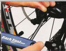
2 COLOCACIÓN DEL CABLE. Con cadena y maneta en piñón pequeño estiramos y sujetamos el cable apretando el prisionero con la llave allen de 5 mm. Colocarlo correctamente en la muesca-ranura del prisionero para asegurar un perfecto sincronizado.
